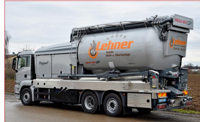
Ein zweiter HochleistungsfILTER ist im Mischbehälter für staubfreie Gebläseluft integriert. Gemeinsam mit der vergrößerten Mischerbefüllleitung (DN 150) erreichen Sie beim MEGA MIX duo höchste Mahl- und Mischleistung im Dauerbetrieb, sowohl bei 2 getrennten Mischungen als auch bei einer Großmischung.
