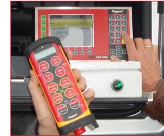
Die vielseitige Funk-Fernbedienung **TFT 11** ist äußerst robust, zeigt Ihnen das aktuelle Mischergewicht und erlaubt Ihnen, **18 Funktionen** an der Mahl- und Mischanlage zu bedienen. Benötigt kein Mobilfunknetz!
