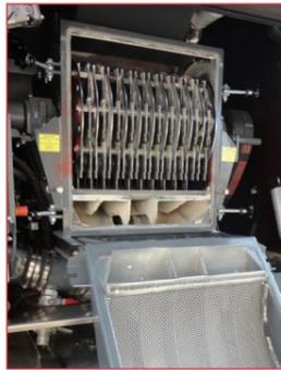
Ausgerüstet mit 160 Original - HM-Schlägern. Bessere Mahlarbeit durch 30% mehr Siebfläche - 1,1 m<sup>2</sup>. Der Siebwechsel ist auf einfachste Weise **werkzeuglos** möglich.
