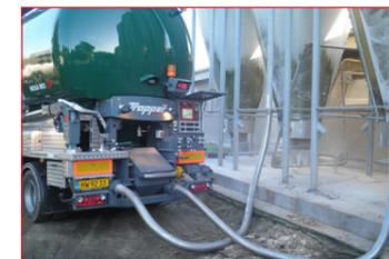
Erhöhen Sie die Ausblasleistung auf bis zu 80 to/h durch Einsatz einer zweiten Ausblasleitung (siehe Foto). Zum gleichzeitigen Einfüllen von großen Futtermengen in mehreren Silos vielfach erprobt!
